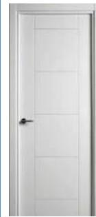
Carpintería de madera en DM lacada y/o barnizada, hojas abatibles de 725x203x35 mm, lisas y/o decoradas con canal tipo pico gorrión con aireadores ocultos homologados, herrajes de acero 4 pernos, manivelas de acero y con condena en baños, plinto por ambas caras y recercados con molduras de 90 mm sin clavos.
