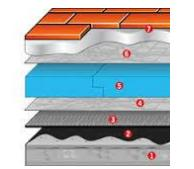
Formación de cubiertas transitables plana constituida por mortero semi-seco para formación de pendientes, con formación de medias cañas, imprimación asfáltica doble lámina de betún dosificado la primera con armadura de fibra de vidrio y la segunda con polietileno de refuerzo en encuentros con gravilla. fabricas con tela auto-protectora de pizarilla, fieltro geotextil.
